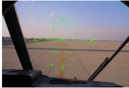
Figura 14 Head-up display o HUD en el panel frontal de la cabina de un avión. Fuente: C-130J co pilot's head-up display, Telstar Logistics, Wikimedia Commons, CC BY 2.0 ( https://goo.gl/zgYfSy ).
